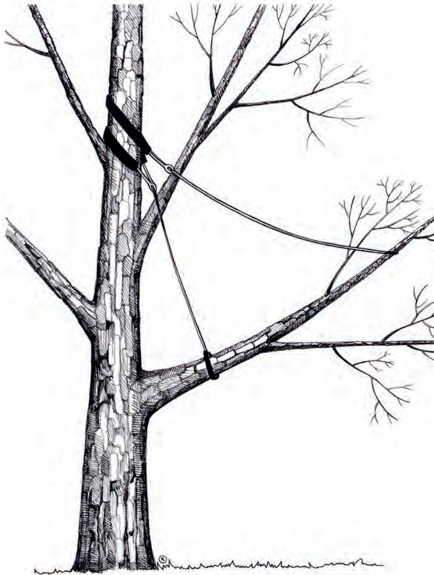
Figura 6: Asegurar una rama horizontal para evitar daños en caso de fallo
