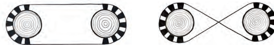
Figura 16: Formas recomendadas de instalar el sistema de cable y listones
