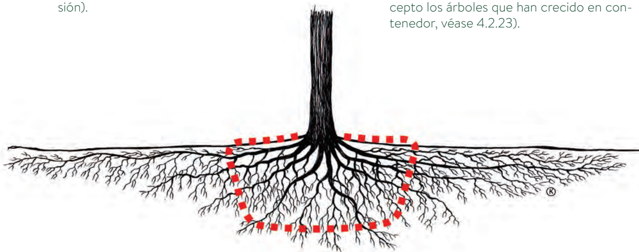
Figura 5: El cepellón de un árbol de vivero está formado por sólo un 5-10% del volumen total de raíces que el árbol habría alcanzado si se hubiera plantado en el suelo.
