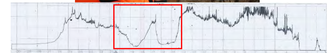
Realización de resistografías en un chopo, y resultado (zona alterada en recuadro).
