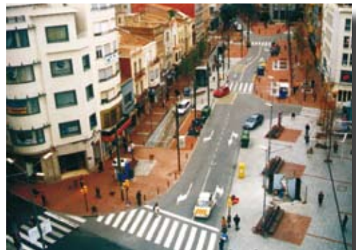
Calle de Tarrasa antes y después de la intervención; ampliación de aceras, eliminación de estacionamiento en superficie y reducción del número de vehículos circulando (Foto: Ayuntamiento de Tarrasa)
